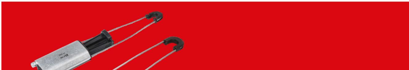
Зажимы анкерные клиновые PA1000, PA1500, PA 95-2000 предназначены для фиксации провода СИП на магистрали и ответвлениях. Обеспечивают необходимое натяжение провода в анкерном пролете линии. Корпус изготовлен из алюминиевого сплава с высокой устойчивостью к механическому и климатическому воздействию. Клинья зажима изготовлены из погодо- и ультрафиолетостойкого стеклонаполненного полиамида. Специальный рельеф поверхности клиньев надежно фиксирует проводник, не повреждая при этом изоляцию.
