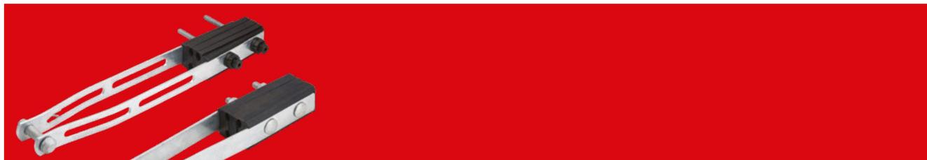
Зажимы анкерные HELL-5506, HELL-5507, PA-4120, SO234M предназначены для крепления абонентской линии из двух или четырех проводов. Зажимы предусмотрены для проводников сечением от 16 до 120 мм<sup>2</sup>. За счет пружины в прижимных механизмах монтаж проводника становится быстрее и удобнее. Зажимы изготовлены из стали горячего цинкования, устойчивой к коррозии, полимерные вставки выполнены из стеклонаполненного полимида PA66.
