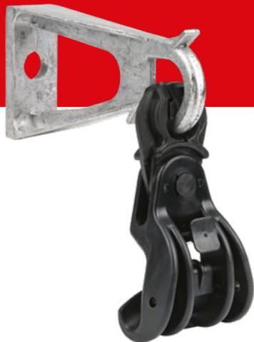
Комплект промежуточной подвески ES1500/ES1500ECO предназначен для крепления несущей нейтрали на промежуточных и угловых опорах при углах отклонения до 50° при подвеске с внешней стороны линии и при углах отклонений до 30° при подвеске внутри линии. При больших углах применяются два анкерных клиновых зажима. Конструкция состоит из кронштейна и установленного зажима PS1500 LM.
