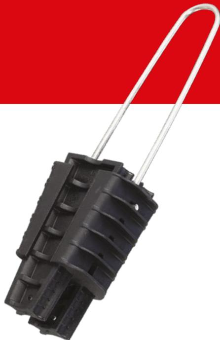
Зажим анкерный клиновой PA25x100 предназначен для крепления абонентской линии из двух или четырех проводов. Специальный рельеф поверхности клиньев надежно фиксирует проводник, не повреждая при этом изоляцию. Легкий монтаж без использования инструмента. Увеличенная до 350 кгс разрушающая нагрузка позволяет монтировать пролеты до 40 м.
