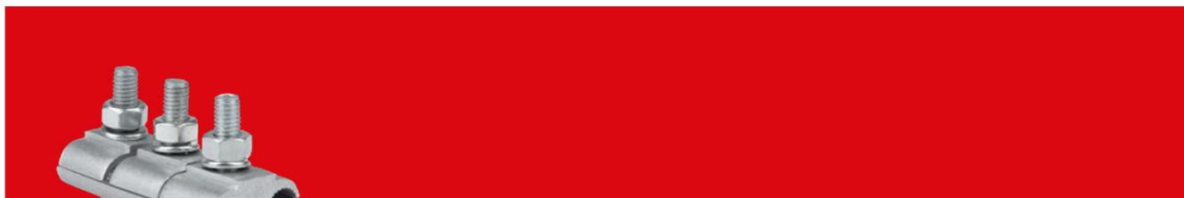
Зажимы ПА применяются для соединения алюминиевых и сталеалюминиевых проводов в петлях анкерных опор ВЛ и осуществления отпаек. Зажимы ПА применяется также для крепления петли проводов при анкерном креплении на штыревых изоляторах. Корпус зажима изготовлен из алюминиевых плашек, стягиваемых при помощи болтов в климатическом исполнении УХЛ категории 1 по ГОСТ 15150. Кронштейн устойчив к УФ-излучению, повышенной и пониженной температуре, к тепловому и световому воздействию солнечной радиации.
