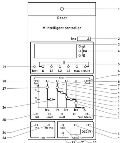
1. Кнопка-индикатор автоматического срабатывания от сверхтока и разрешения на включение автоматического выключателя.
