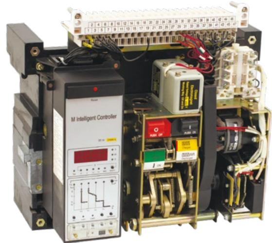
Автоматические выключатели серии BA-45 EKF PROxima являются воздушными выключателями с механизмом свободного расцепления и оперирования контактами посредством механизма с пружинным накопителем энергии.
